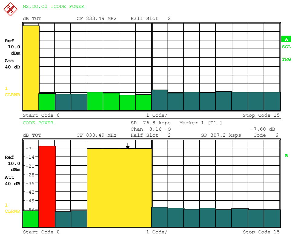
Bild 6-11 CDP-Diagramm in BitReverse-Ordnung im Überblicksmodus
